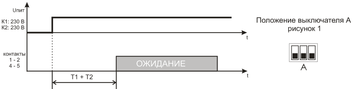
Рисунок 3 – Алгоритм работы Реле с задержкой на включение
