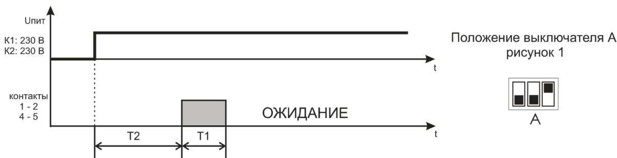
Рисунок 4 – Алгоритм работы Реле импульсное 1
